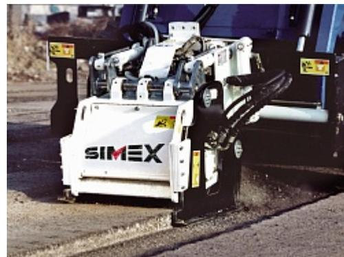
Ямочный ремонт навесной фрезой, удаление старой дорожной разметки, выпиливание продольной выемки при стыковке ново улаженной асфальтобетонной смеси и старой, фрезерование небольших участков для последующей укладки нового асфальтного покрытия – Simex.
