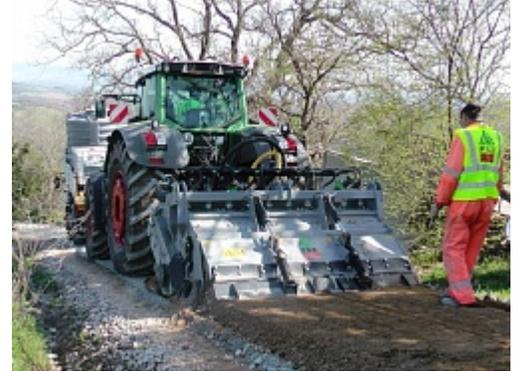
Модель позволяет стабилизировать грунт, фрезеровать каменные плиты, измельчать камни, фрезеровать асфальт на глубине до 40 см.
